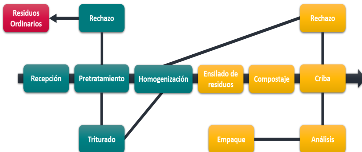
Ilustración 6. Proceso de producción del compostaje en bolsas silo
